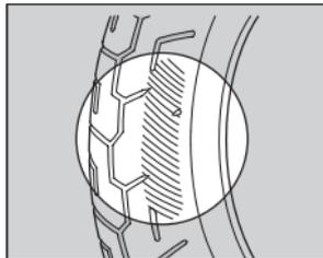
Inspeccione los neumáticos en busca de signos de desgaste anormal en la superficie de contacto.
