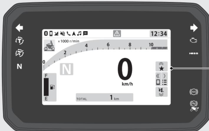
No utilice las funciones de la pantalla durante mucho tiempo con el motor parado. Podría descargar la batería (hasta un nivel bajo o por completo).
