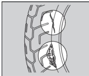
Compruebe la existencia de cortes, rajaduras o grietas que expongan la tela o los cordajes, o posibles clavos u otros objetos extraños incrustados en el lateral del neumático o en su banda de
