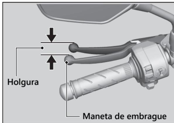
Compruebe que el cable de embrague no esté retorcido y que no muestre señales de desgaste. En caso necesario, haga que lo sustituyan en su concesionario.
