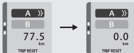
Además, el cuentakilómetros parcial A, el consumo de combustible del cuentakilómetros parcial A y el kilometraje medio por combustible del cuentakilómetros parcial A se reinician automáticamente cuando el segmento del indicador de combustible aumenta en 2 o más después de repostar y conducir el vehículo durante 0,1 km. Puede activar o desactivar el modo de reinicio automático. ➔ **P.43**
