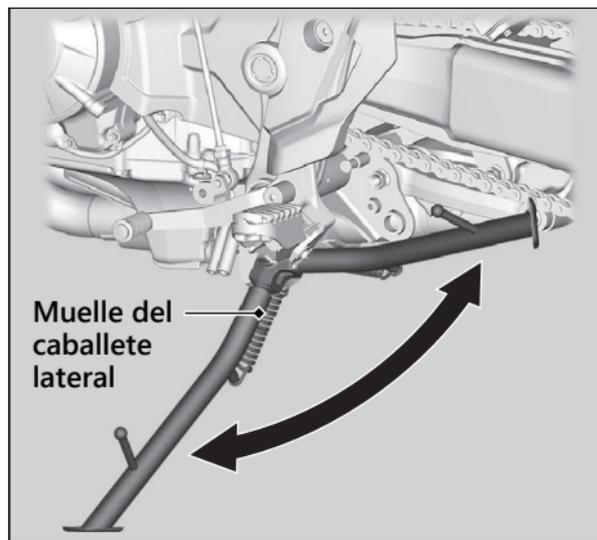
1. Compruebe que el caballote lateral funciona debidamente. Si el caballote lateral resulta difícil de colocar o chirría, limpie la zona de giro y lubrique el tornillo del basculante con grasa limpia.
