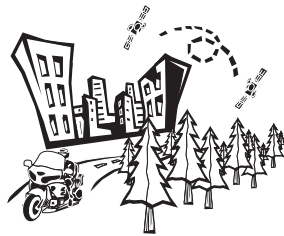
Posición baja del satélite GPS en el horizonte (inferior a 10 grados).
