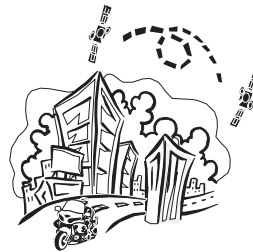
Posición baja del satélite GPS en el horizonte (inferior a 10 grados).
