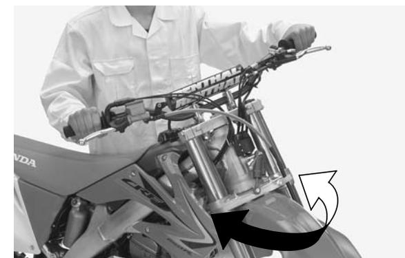
4. Instale la matrícula (3) alineando sus orificios (7) con las lengüetas (8) del vástago de la dirección. Instale y apriete los pernos (2) con seguridad. Pase la lengüeta de la placa de la matrícula (1) en torno al acolchado del manillar (9) como se muestra.
