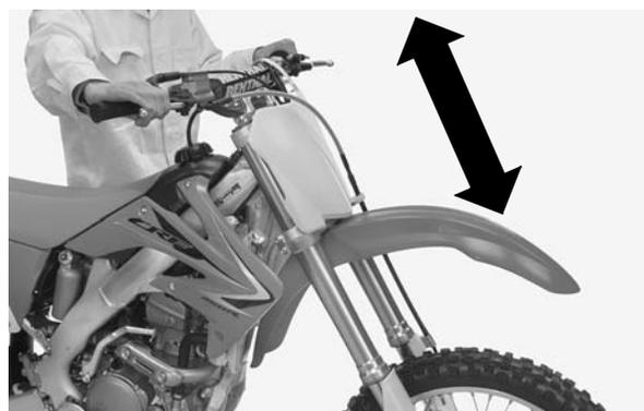
30. Mientras mantiene paralelas las horquillas, apriete alternadamente los pernos de fijación del eje derecho (30) a la torsión especificada:
