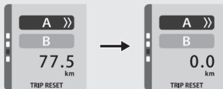
Además, el cuentakilómetros parcial A, el consumo de combustible del cuentakilómetros parcial A y el kilometraje medio por combustible del cuentakilómetros parcial A se reinician automáticamente cuando el segmento del indicador de combustible aumenta en 2 o más después de repostar y conducir el vehículo durante 0,1 km. Puede activar o desactivar el modo de reinicio automático. ➔ **P.51**
