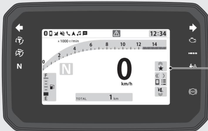
Puede cambiar la unidad de kilometraje y velocidad, y la unidad del medidor de kilometraje por combustible. ➡ **P.43** ➡ **P.61**
