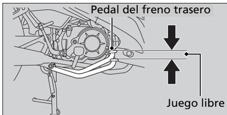
Asegúrese de que la varilla del freno, el brazo del freno, el muelle y el dispositivo de ajuste estén en buenas condiciones.
