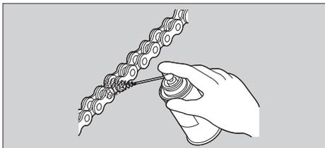
Nunca utilice gasolina ni disolventes de bajo punto de inflamación para limpiar la cadena de transmisión.
