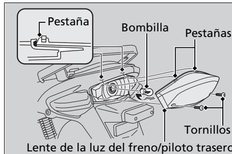
1. Extraiga la lente de la luz del freno/piloto trasero extrayendo los tornillos y liberando las pestañas.
