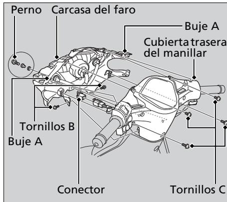
7. Extraiga los tornillos B, los tornillos C y el perno.
