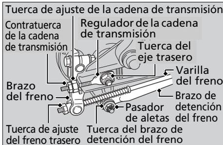
5. Afloje las contratuercas de la cadena de transmisión y las tuercas de ajuste de la cadena de transmisión en ambos lados del basculante.
