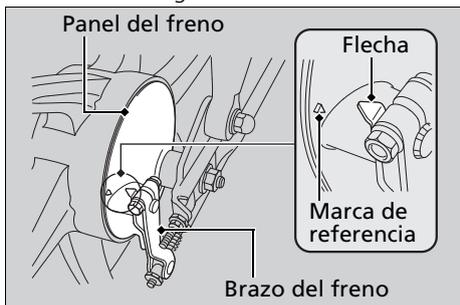
Cuando se acciona el freno, la flecha unida al brazo del freno se mueve hacia una marca de referencia en el panel del freno. Si la flecha se alinea con la marca de referencia al accionar el freno a fondo, es necesario reemplazar las zapatas de freno.
