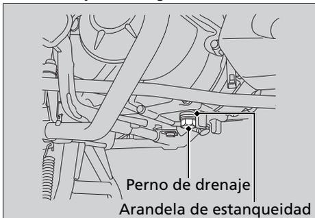
6. Instale una arandela de estanqueidad nueva en el perno de drenaje. Apriete el perno de drenaje.
