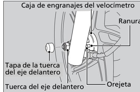
7. Una vez instalada la rueda, aplique varias veces los frenos y compruebe si la rueda gira libremente. Vuelva a comprobar las ruedas si el freno arrastra o si las ruedas no giran libremente.
