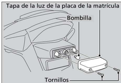
1. Extraiga los tornillos y la tapa de la luz de la placa de matrícula.
