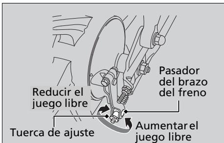
1. Realice el ajuste girando la tuerca de ajuste del freno trasero media vuelta cada vez.
