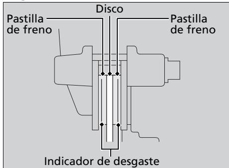
Inspeccione las pastillas de freno desde debajo de la pinza del freno.
